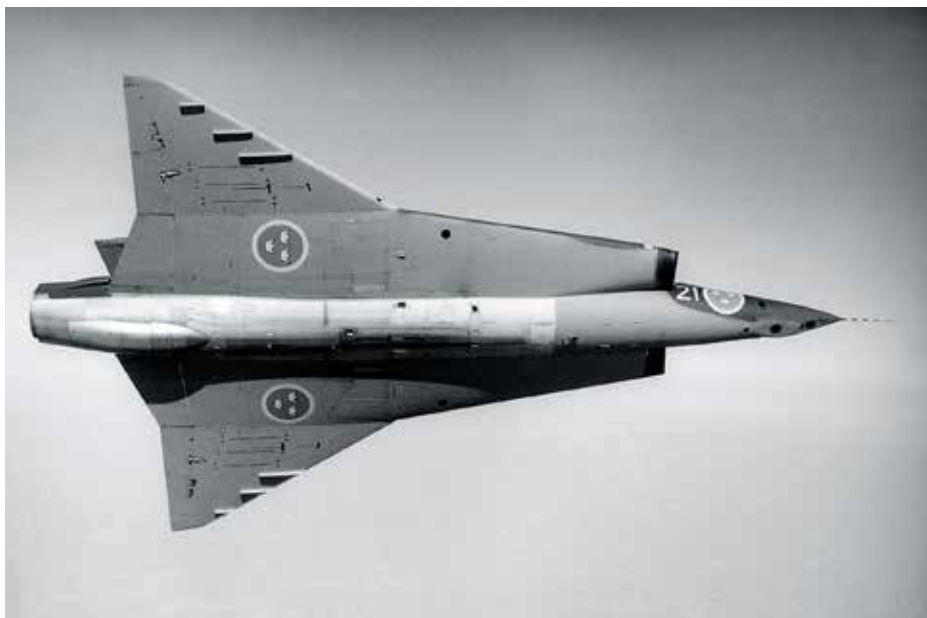
S35E Draken sedd underifrån där kamerasystemets öppningar syns. Foto i F 21:s arkiv.
