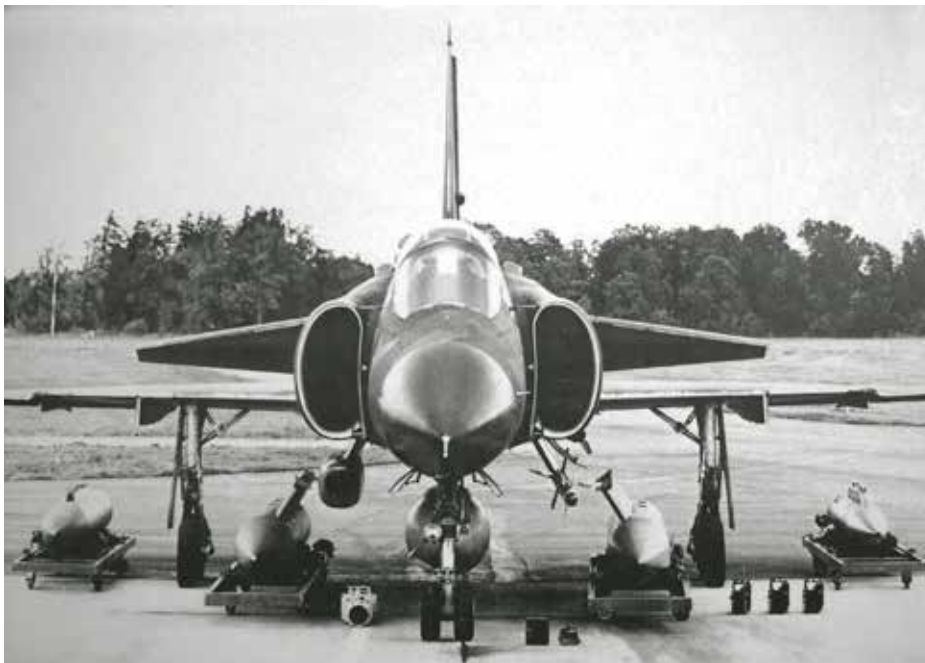
SH 37 har sin radar som primär spaningsutrustning. På höger sida av flygkroppen sitter en fast monterad främtriktad kamerakapsel med en avståndskamera, SKA 24D (600 mm) för fotografering av främst sjösmål. SH 37 kan bära samma mörkerspaningskapsel som SF 37 på vänstra kroppsbalken, dock saknas högra kapseln med extra blixtrar. Båda flygplanstyperna kan utrustas med motmedel: kapsel KA, aktiv störare samt KB med remsor och facklor. Foto i F 21:s arkiv.
