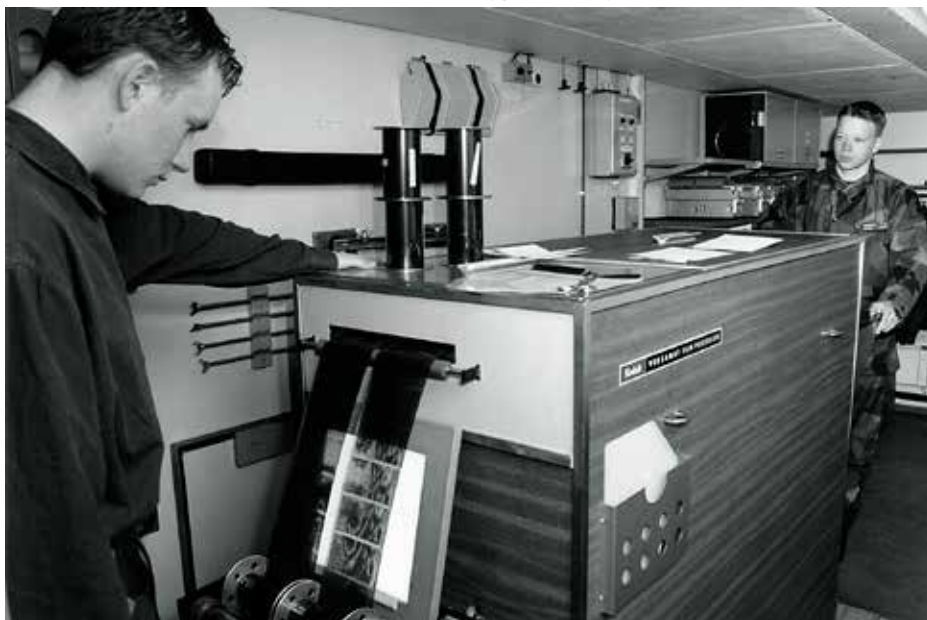
Den effektiva Versamaten framkallade och torkade flygfilmerna på fyra minuter. Foto i F 21:s arkiv.
