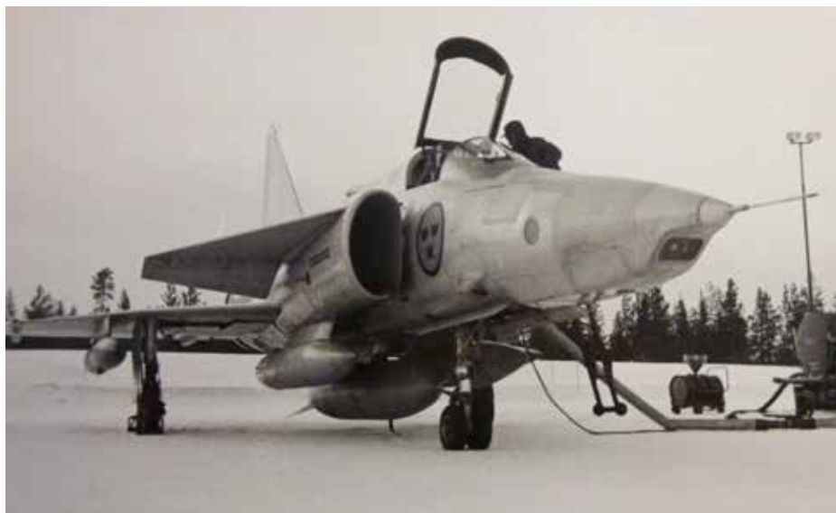
SF 37 prototyp, 37950 (37033), på F 21 för vinterprov, troligen 1976. Notera motmedelskapslarna, KA och KB, på resp vinge. Foto i F 21:s arkiv.
